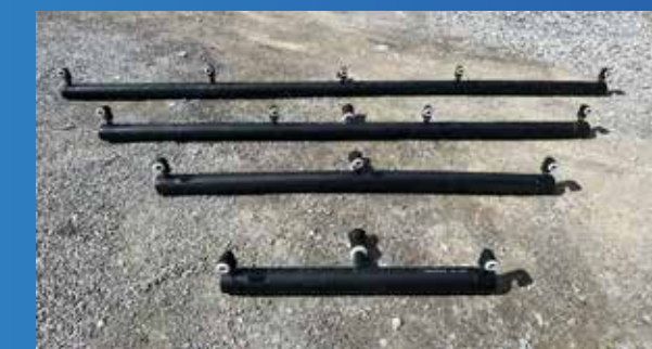
Manifoiler med 2, 3, 4 og 5 uttak. Det er laget med Ø110mm rør. Inntak er 50mm Uttak er 32mm.
